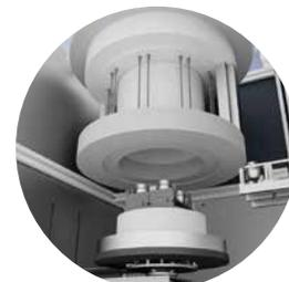
geschlossenes Ofendesign mit Aufzugboden für genaue Temperaturkontrolle
